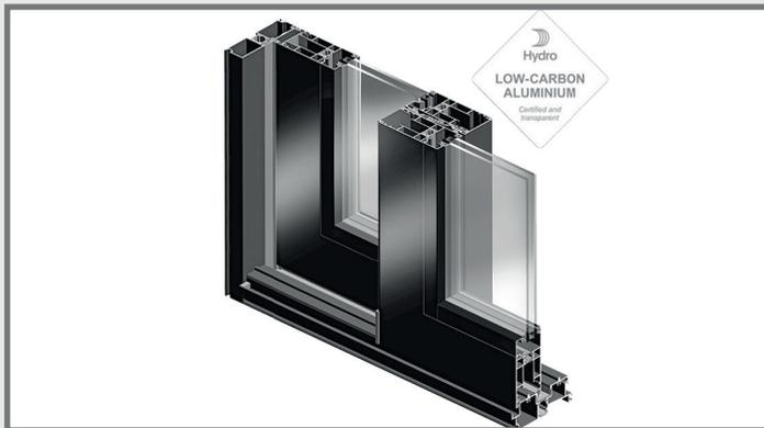
A CAIXILHARIA DE ALUMÍNIO QUE SERÁ APLICADA AO EDIFÍCIO PRIME II @ NATÁLIA CORREIA É ASSEGURADA PELA TECHNAL BY HYDRO, COM ACABAMENTO LACADO TEXTURADO DE DESIGN PREMIUM, COM CORTE TÉRMICO E VIDROS DUPLOS COM CAPA SOLAR INTEGRADA DOTANDO ESTE CONJUNTO O MELHOR CONFORTO TÉRMICO E ACÚSTICO AO SEU APARTAMENTO.
